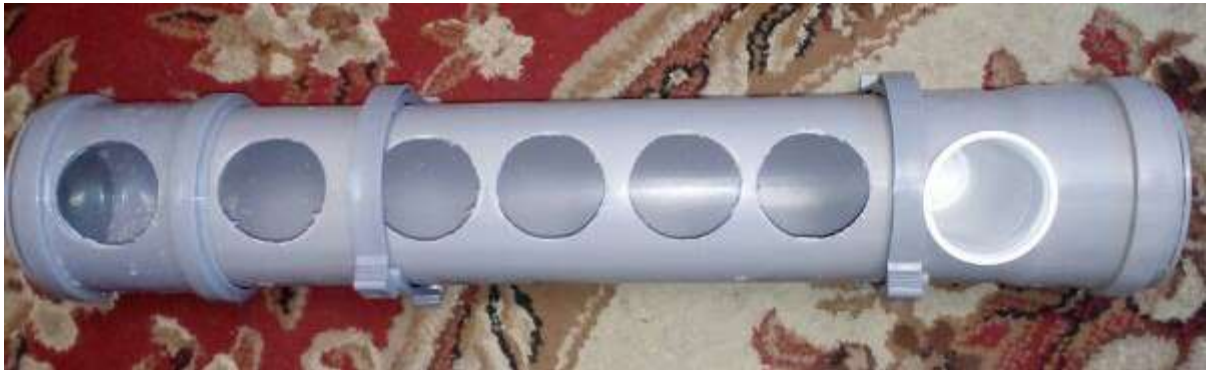
Рис. 3 Основа гидропонной установки
